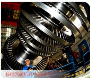
核电汽轮机高中压转子
