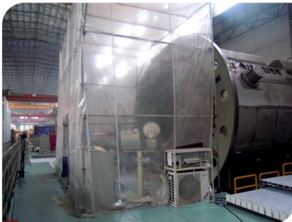
制定适合各单位的洁净化封闭作业区工艺布局规划、局部隔离作业工艺布局规划及洁净化装置改善升级等方案。
