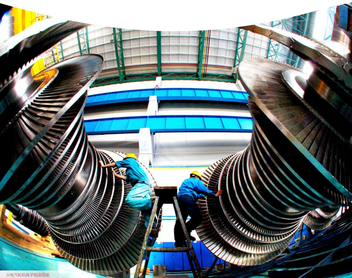
火电汽轮机转子制造现场
